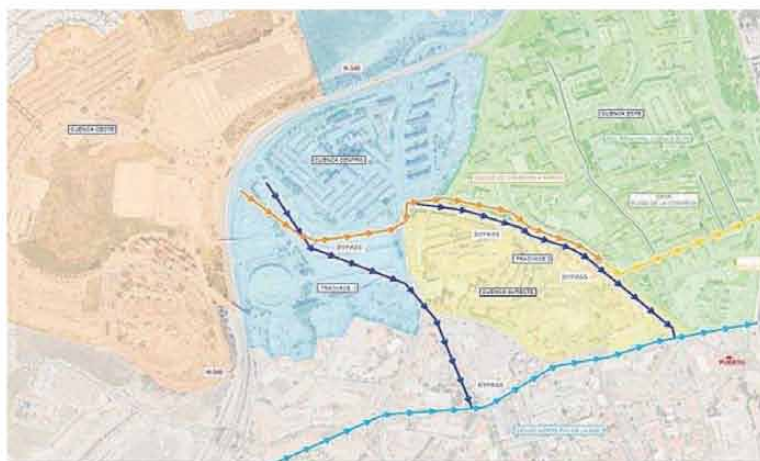
Los dos bypass / colectores que construirá Acuaamed para rebajar la presión sobre el colector de Jacinto Benavente.
